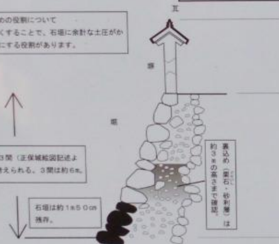
図2 石垣と裏込めの断面解説図
